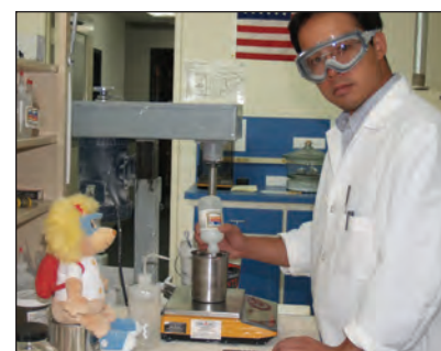
Meg con el químico Hai Nguyen, explicando cómo se fabrica pintura con un dispersor.
